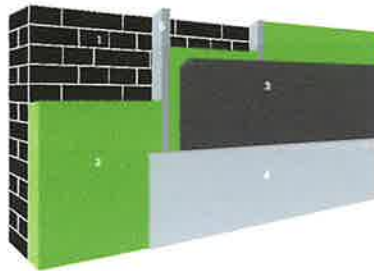
1. Buitenmuur | 2. Isolatie | 3. Vochtshield | 4. Afwerkingslaag | 5. Stijl- en regelwerk (optioneel)
