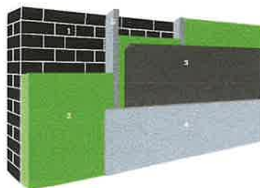
1. Buitenmuur | 2. Isolatie | 3. Vochtscherf | 4. Afwerkingslaag | 5. Stijl- en regelwerk (optioneel)
